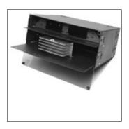
Carcasa de fibra de 6-48, bandeja deslizable. Montaje negro de 24 puertos con acceso de conexion frontal y trasera y 2 bandejas de empalme integradas. Bandeja abajo con capacidad de hasta 4 bandejas. Bandeja frontal removible
